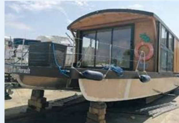
La Nacelle : Les flotteurs sont en Strongal (alu épais) COMPLÈTEMENT RECYCLABLE, SANS ENTRETIEN ET SANS PEINTURE. Constructeur : METACHANTIER A TARARE
