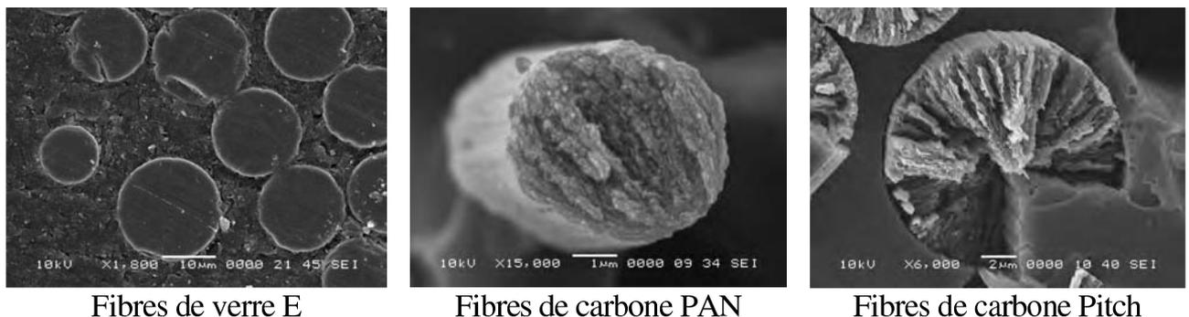
FIG. 2.8 – Observation MEB de sections de composites - Mise en évidence de la micro-structure des fibres de verre et de carbone.
