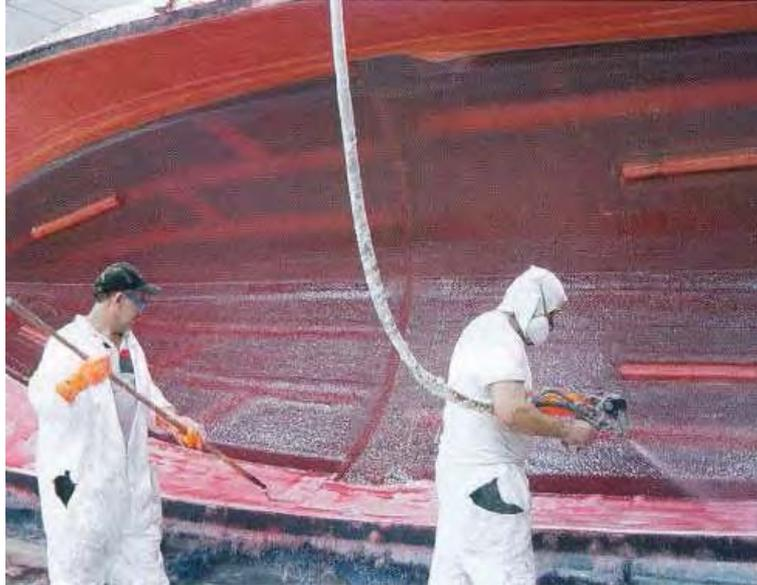
FIG. 1.4 – Projection simultanée.
