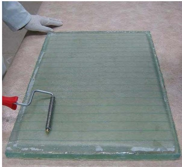
FIG. 6.1 – Réalisation de plaques stratifiées par moulage au contact.
