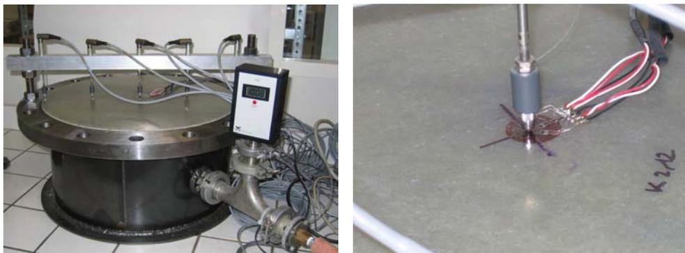
FIG. 8.5 – Montage expérimental et instrumentation des plaques.
